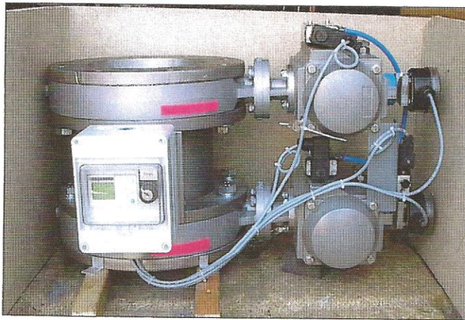
Abb. 3: Taktchleuse als Standard-Ausführung mit Steuerung
